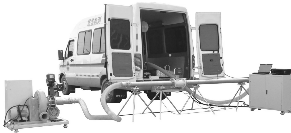
图8 车载结构的标准表法装置
