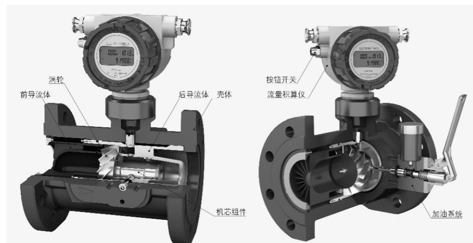
图1 流量计原理结构图
