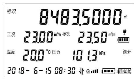
图3 正常运行时修正仪显示
