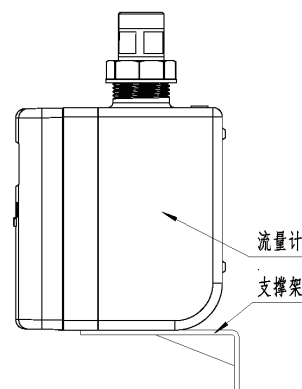
图8 支撑架安装示意图
