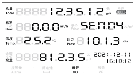
图 6-15 远程通讯连接时显示“SEND”
