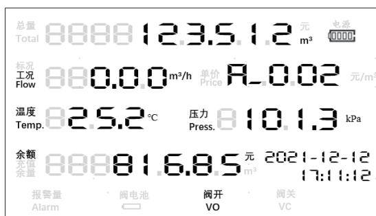
图 6-4 表端金额结算第二屏 (A_002 表示 Modbus 地址为 2)
