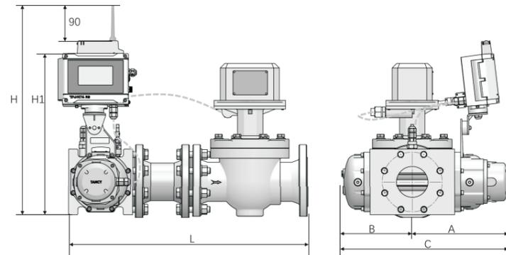
图5-10 TYLZ-G□-B/TCVL-B-□-R水平安装
