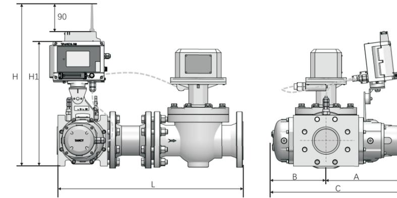
图5-5 TYL-G□C-B水平安装
