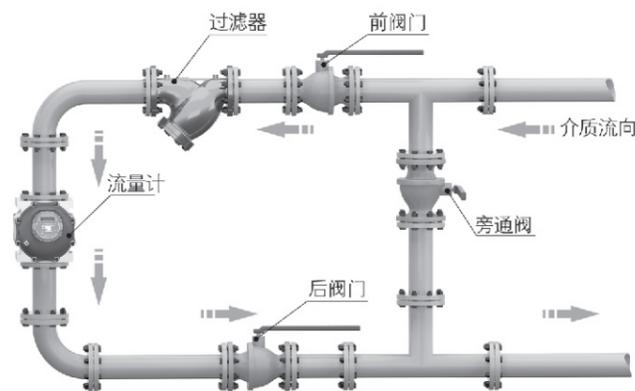
图7 垂直安装示意图
