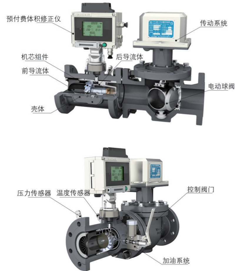
图 1 流量计结构图
