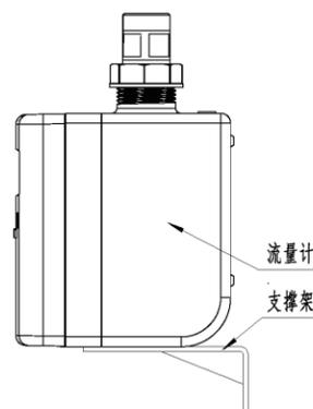
图8 支撑架安装示意图
