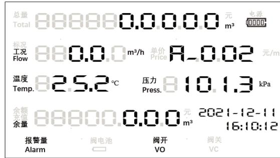
图 6-8 表端气量结算第二屏（显示 Modbus 地址）
