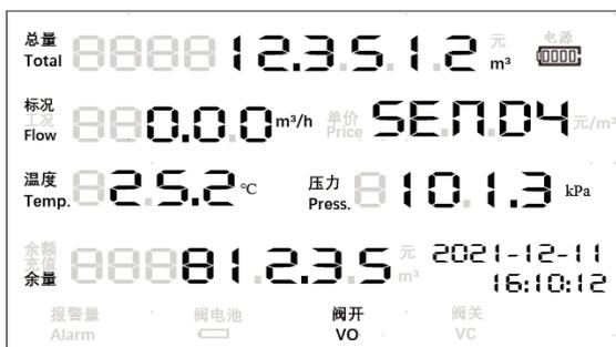
图 6-15 远程通讯连接时显示“SEND”
