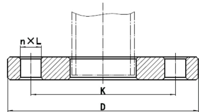
图6-1 平面 (FF) 板式平焊钢制管法兰
